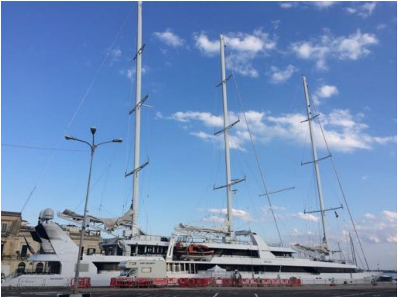
Der Dreimaster ist 88 Meter lang und 11 Meter breit; wahlweise wird er mit 1500 m<sup>2</sup> Segeln oder 1700 kw Motorleistung bewegt. Das Passagier-Crew Verhältnis kann man nur als ausgewogen dekadent bezeichnen: 64 zu 32.
